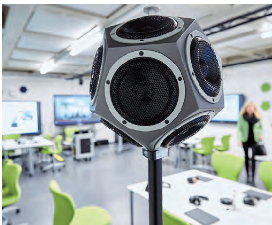
Empfindliche Messinstrumente geben Aufschluss darüber, wie Kursräume gestaltet sein müssen, damit Kursteilnehmende eine optimale Akustik genießen können.
